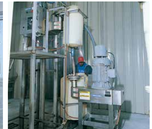
Des particules uniformes de poivrons sont produites au cours d'une opération de broyage en deux étapes à l'aide de deux modèles 1500.
