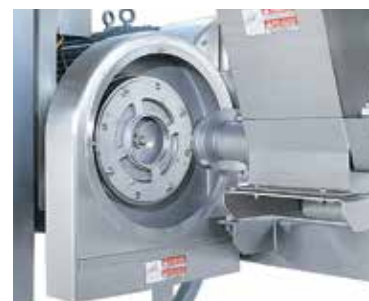
Unité de coupe après retrait du capot (à des fins d'illustration)
