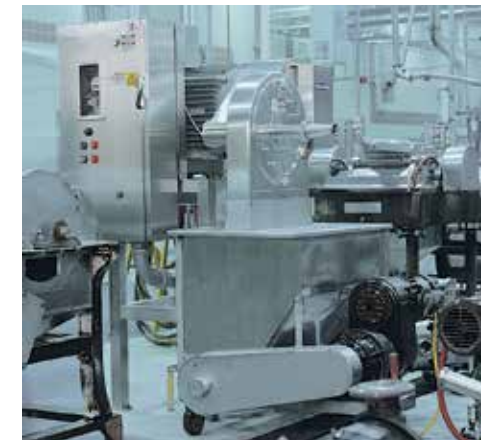
Le modèle 9300 est utilisé pour broyer des fruits et des légumes en une fine purée pour la production d'aliments pour bébés.
