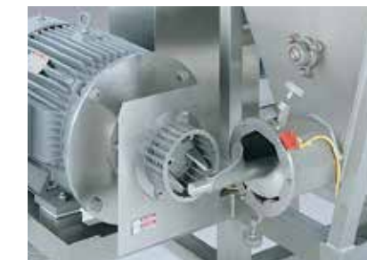
Unité de coupe après retrait du capot (à des fins d'illustration)
