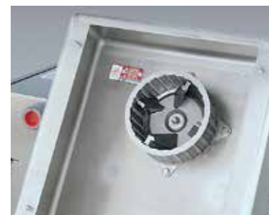
Unité de coupe après retrait de l'enceinte de coupe (à des fins d'illustration)
