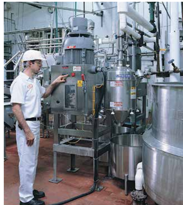
Un broyage uniforme de la peau de volaille est obtenu au moyen de deux modèles 1700 pour la production de concentrés pour potage.
