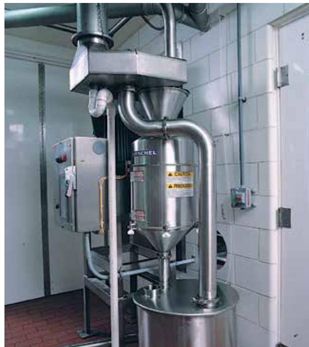
De la peau de volaille est prédécoupée sur un modèle 1700 équipé d'une tête de coupe.
