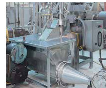
Une réduction en particules uniformes de viandes et de légumes cuits à forte teneur en humidité s'effectue facilement avec le modèle 3000.
