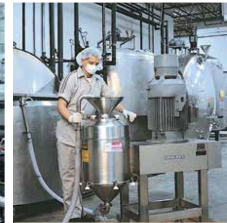
De l'aloë vera est broyé dans le modèle 1700 pour être utilisé dans une gamme variée de produits dermatologiques.
